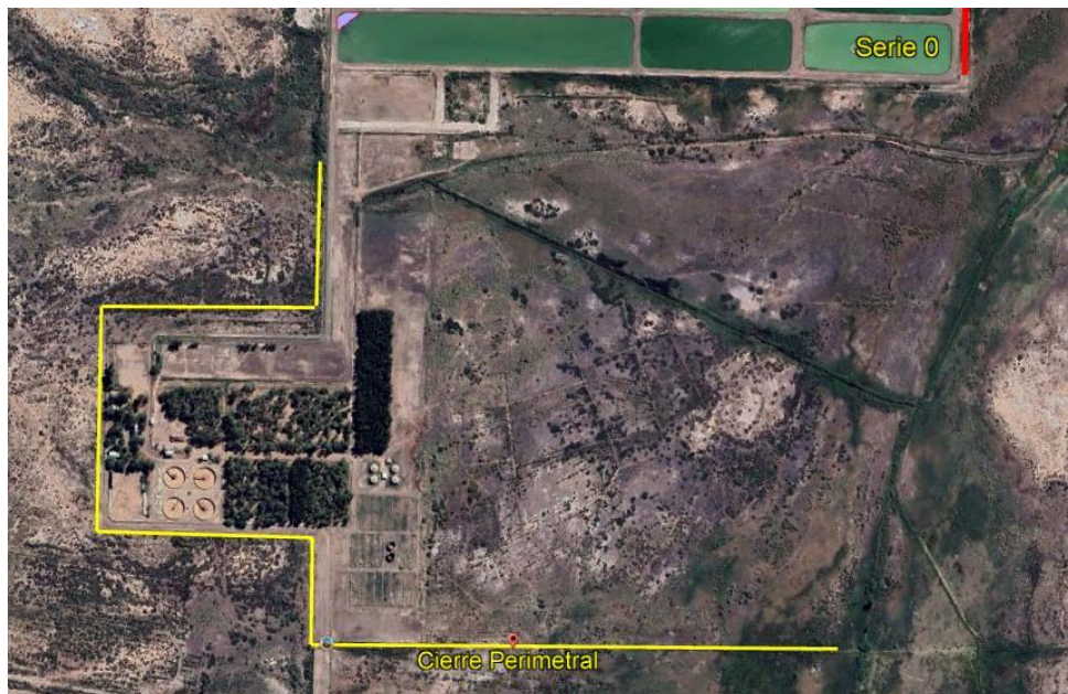
Figura 11: Traza del cierre perimetral a construir
